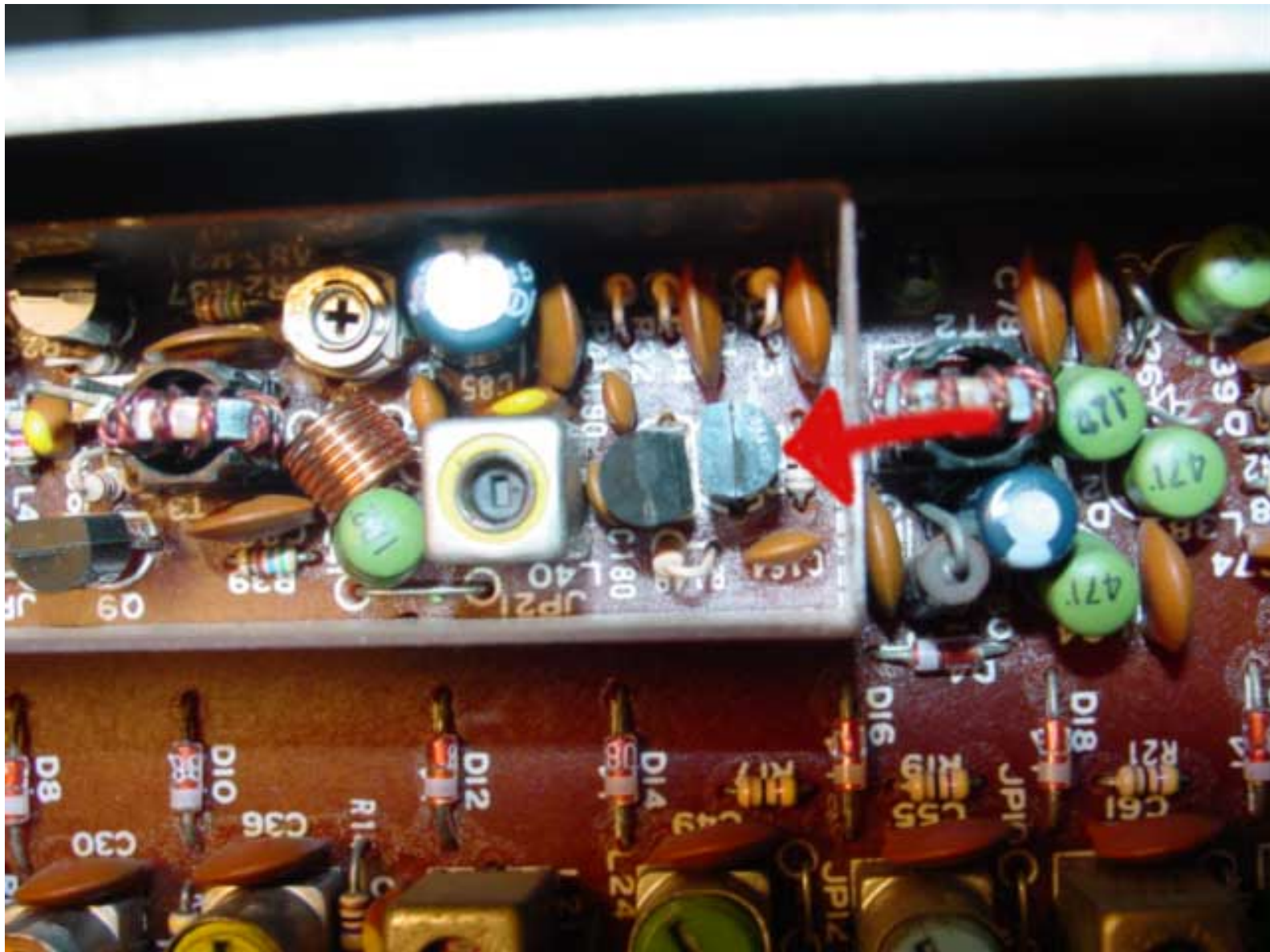
Esta figura muestra el FET en la posición correcta.
